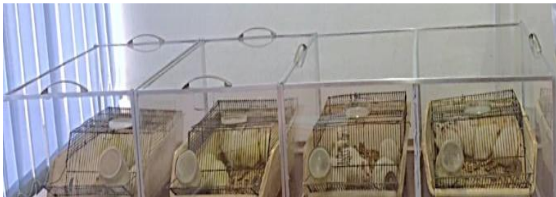
Сурет 6 – Бензин буына арналған ингаляциялық камера, 1,089 м 3 .
